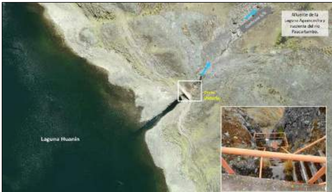
Figura 5-6 Captación de las aguas de la laguna Huanin por medio de la presa Victoria - Zona VII
