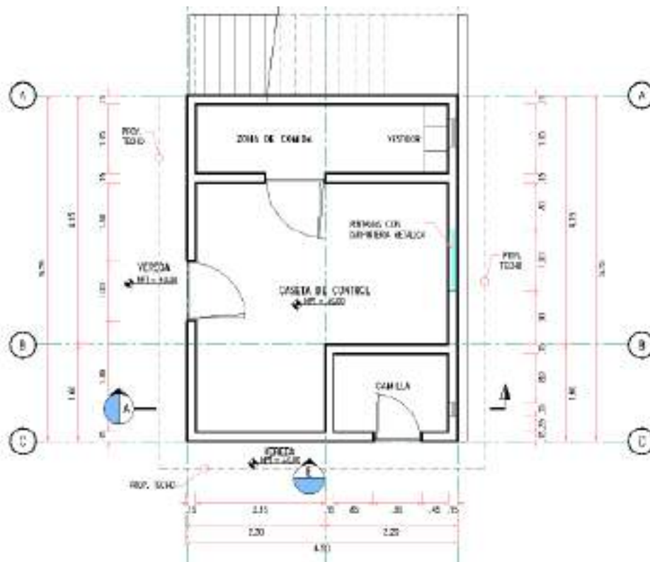
Figura 3-43 Vista en planta de caseta de control.
