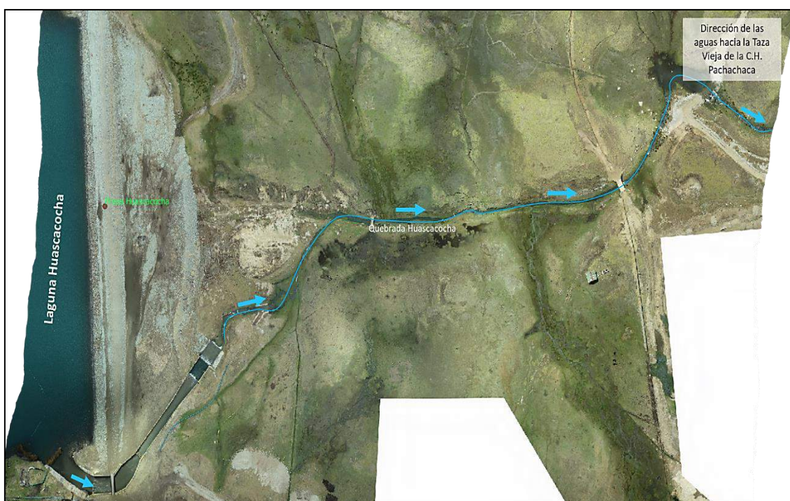
Figura 5-1 Captación y conducción de las aguas de la laguna Huascacocha hacia la Taza Vieja de la CH Pachachaca
