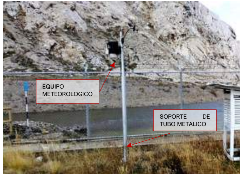
Fotografía 3.3-45 Vista de la estación meteorológica 1 (PAD-CHO-11a)
