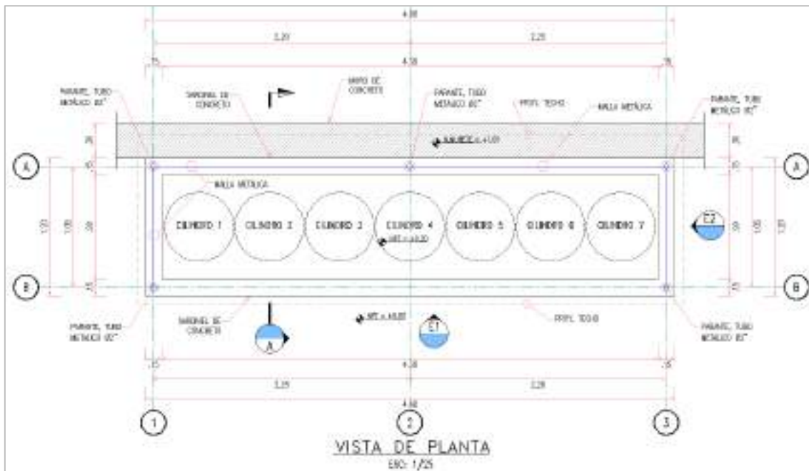
Figura 3.3-58 Vista en planta del Punto de acopio de Residuos Sólidos 1 (PAD-CHO-08a)
