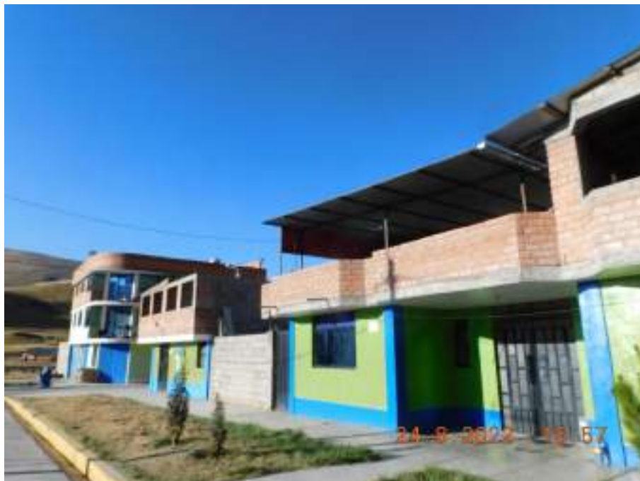
Fotografía 5: Anexo San Miguel, se pudo observar que las viviendas del citado anexo son construidas, por lo general, con ladrillo y cemento, aunque algunos techos son del material calamina o tejas.
