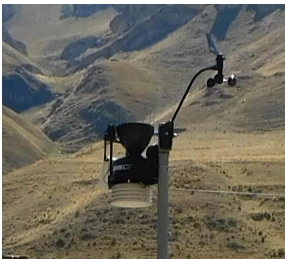
Figura 3.3-9 Equipo estación Vantage Pro2
