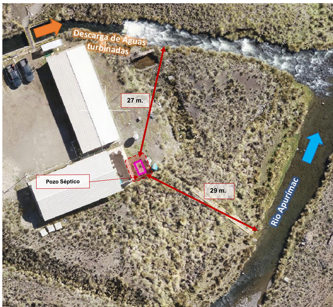
Figura 3-30 Distancia del pozo séptico a cuerpos de agua
