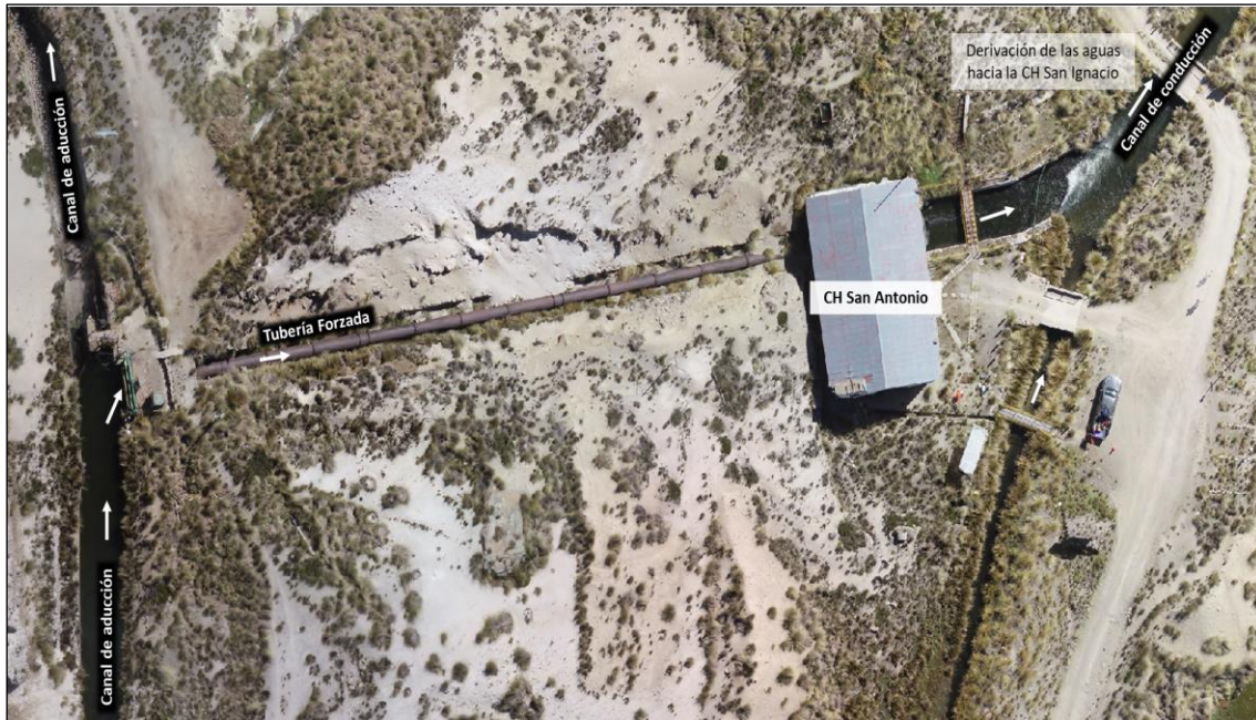
Figura 5-3 Llegada de las aguas mediante canal de aducción a la C.H. San Antonio
