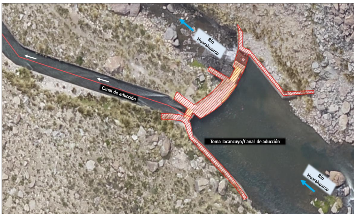
Figura 5-1 Llegada de las aguas del río Huarahuarco a la Toma Jacancuyo/canal de aducción
