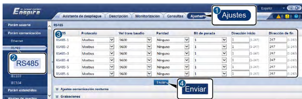
Figura 7-6 Cómo ajustar los parámetros de RS485
